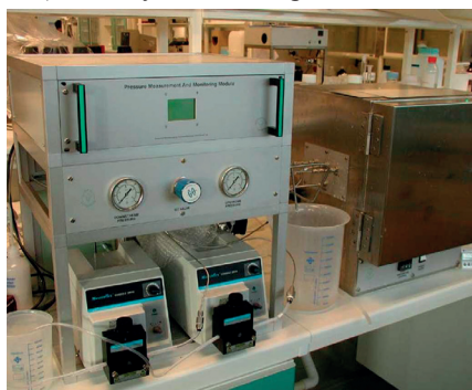
Рис. 3. Установка для моделирования накипеобразования (BPG)
