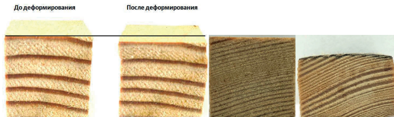
Рис. 4. Восстановление образцов древесины лиственницы после деформирования (до 4500 Н) и снятия нагрузки и отсутствие восстановления образца древесины лиственницы после длительной нагрузки
