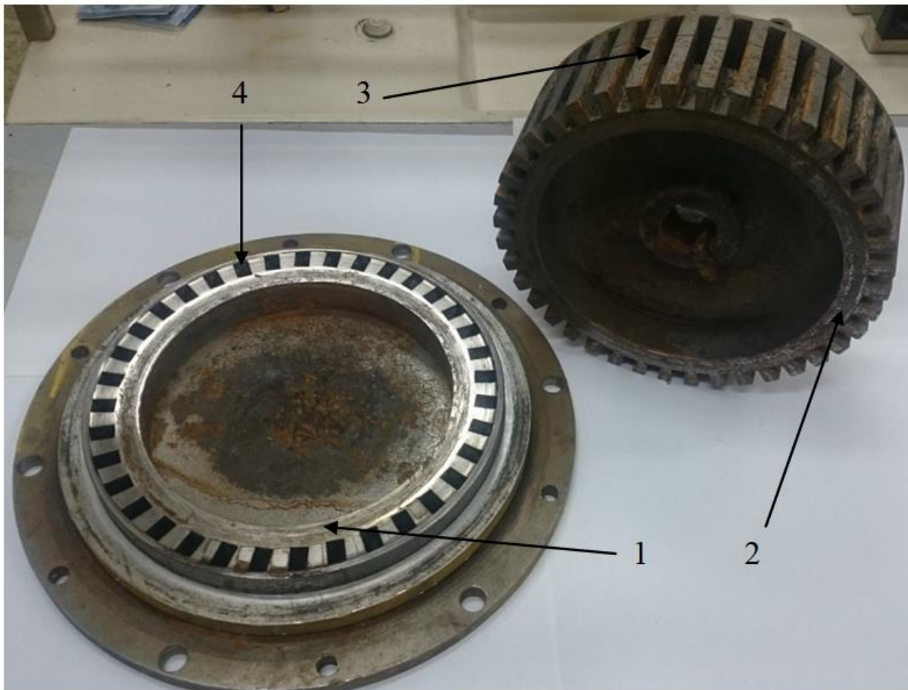
Ротор и статор экспериментальной установки: 1 – статор; 2 – ротор; 3 – резонаторы; 4 - конфузоры
