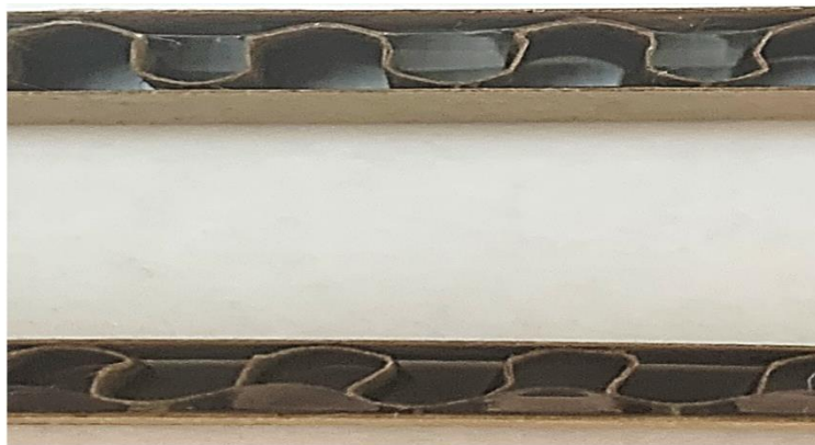
Рисунок 5. Дефект гофра «падающий гофр» (внизу)
