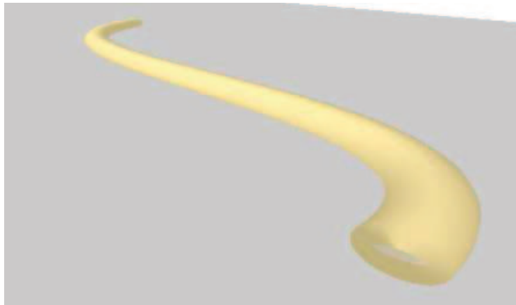
Рис. 1. Модель трехмерного целлюлозного волокна из лиственной целлюлозы с небольшим количеством остаточного лигнина ( l = 0,82 мм, b = 35,7 мкм, f = 89 %)
