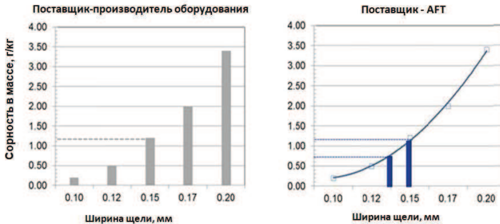
Рис. 2. Ширина щели у поставщика сит (слева) доступна только с установленными шагами; предоставление полного диапазона возможных размеров щелей (справа) позволяет поставщику обеспечить оптимальную ширину щели, которая в этом случае приведет к тому, что целлюлоза будет почти в два раза чище
